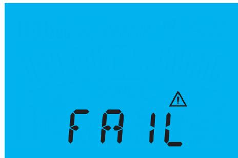
Après chaque auto-test échoué, le générateur de signal/l'émetteur lance automatiquement un nouvel auto-test à la prochaine mise en marche de l'appareil.
